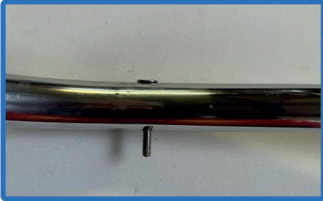
2. Den Leiterholm zur Seite drehen und eine **Stufe oberhalb** auf den Leiterholm durch die Schraube platzieren.
