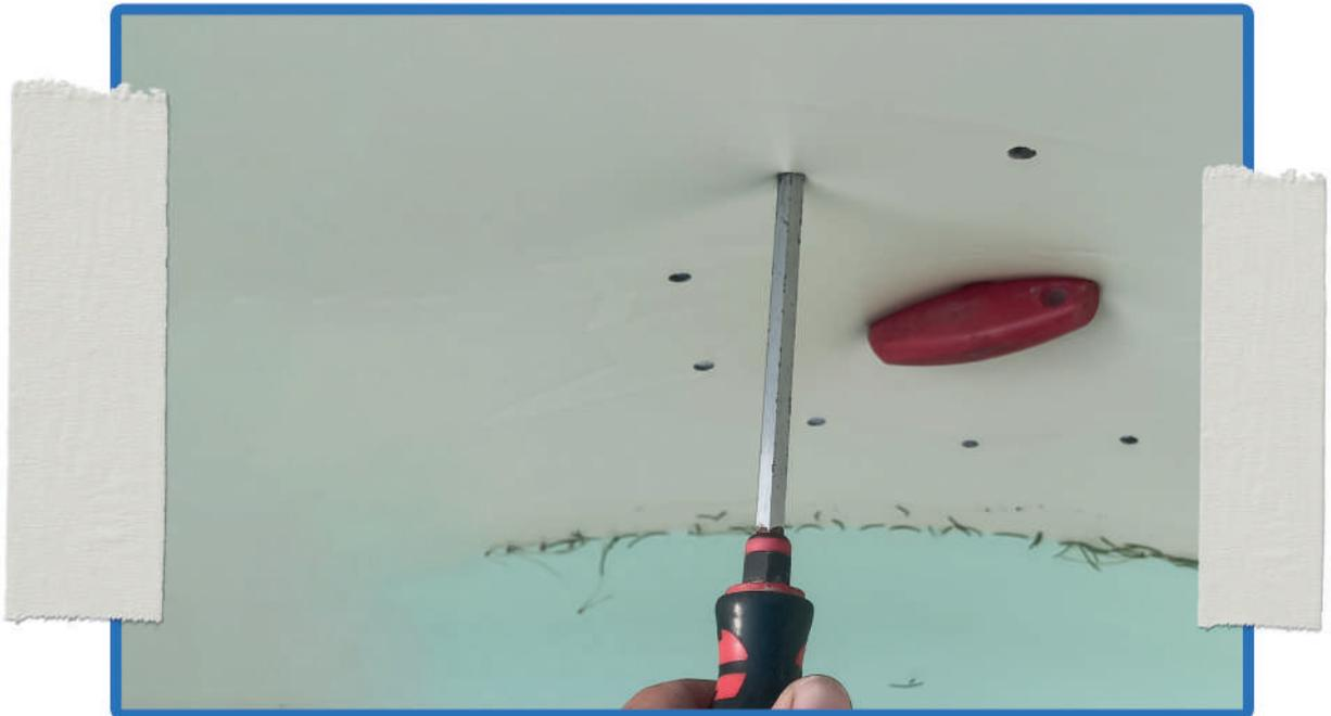
**Wichtig:** Bevor der Halteringsring wieder befestigt wird, muss die mitgelieferte Klebedichtung aufgeklebt werden! Die zweite Dichtung muss auf die Dichtfläche des Scheinwerfertopfes geklebt werden.
