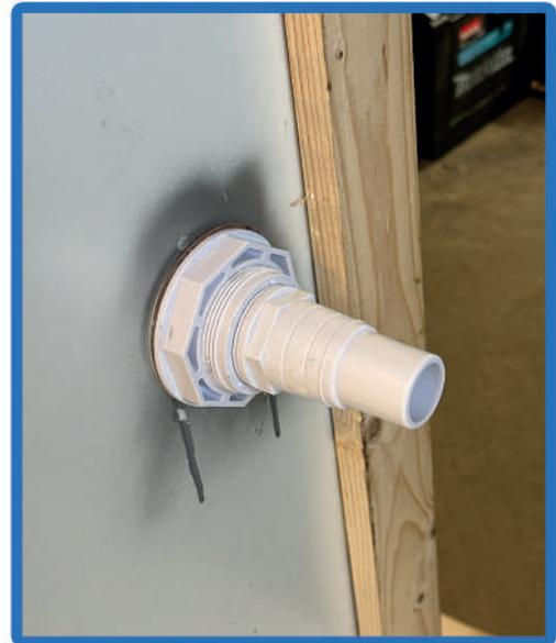
Danach ein **blaues Schlauchsegment** mit einer **Schlauchschelle** befestigen. Dies muss nun für die **zweite Düse** getan werden. Im Anschluss die blauen **Schlauchsegmente** mit dem **T-Modul** verbinden.
